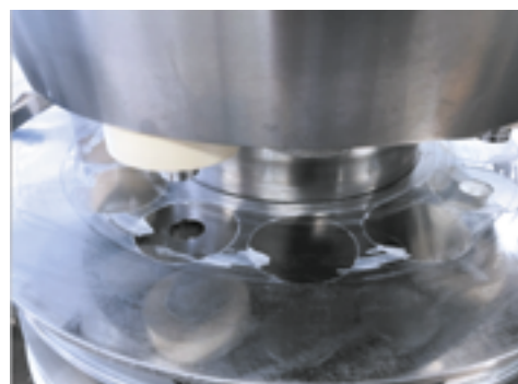
Рисунок 1. Налипание таблеточной массы Ибупрофена с Натрия стеаратом
