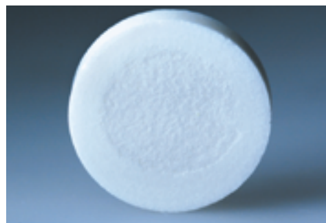
Рисунок 2. Дефекты поверхности таблеток с Магния стеаратом
