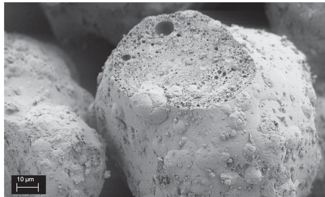
Рис. 1. Поверхность среза инкапсулированного продукта, видимая в электронный микроскоп
