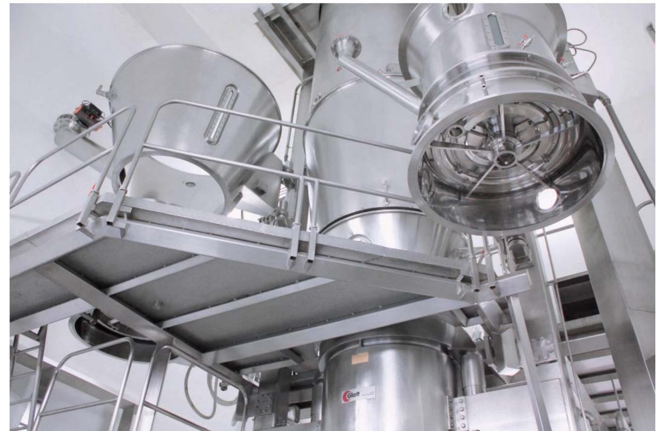
Установка кипящего слоя с разными приставками. Справа рабочая камера струйного псевдооживления типа «ProCell»
