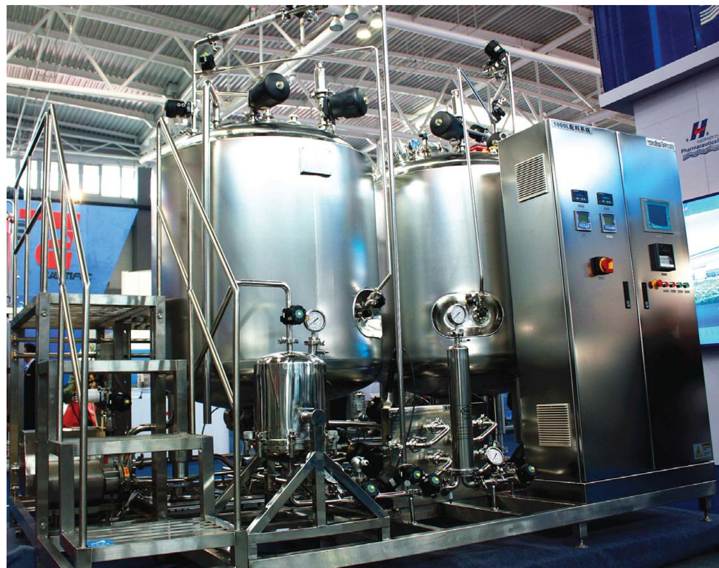
■ Блок изготовления растворов
