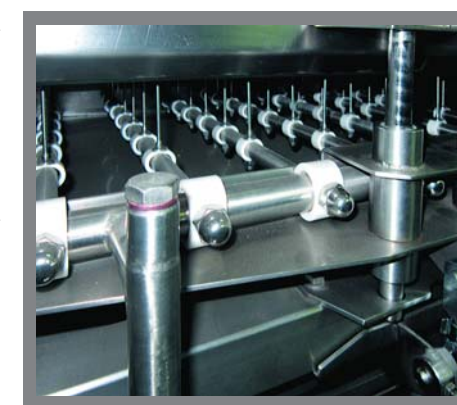
Гребенки подачи сжатого воздуха для осушки внутренней поверхности флаконов
