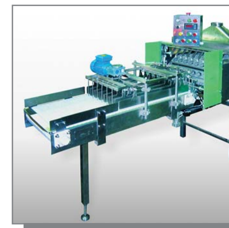
Устройство загрузочное для подачи флаконов с конвейера в кассеты машины
