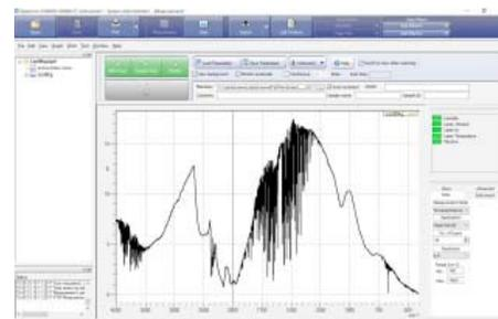
После этого чистый салициловый порошок, чистый аспирин и смеси измеряются для построения калибровочной кривой. Поместите небольшую порцию образца на окно приставки и придавите его, поворачивая рукоятку до характерного щелчка. Аккуратно очищайте окно приставки мягкой тканью с изопропиловым спиртом после каждого измерения.
