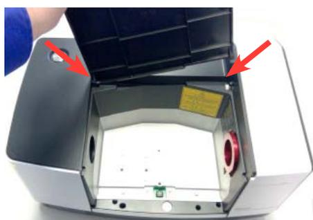
Снимите держатель образца и переднюю крышку IRSpirit. Необходимо поднять крышку в вертикальное положение, а затем вытащить ее из фиксирующих креплений, как показано на рисунке.
