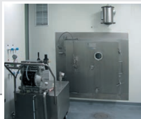
Шкаф MULTISPRAY E1, установленный «через стену» в чистом помещении (с аппаратом мобильной мойки C.I.P.)
