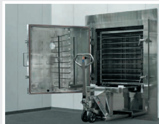
Сушильный шкаф MULTISPRAY E0.9 с извлекаемыми полками и гидравлической тележкой по GMP
