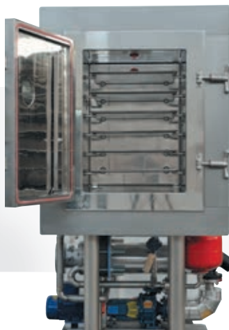
Шкаф MULTISPRAY E0.2 (объем 200 литров), установленный на раме совместно с периферией
