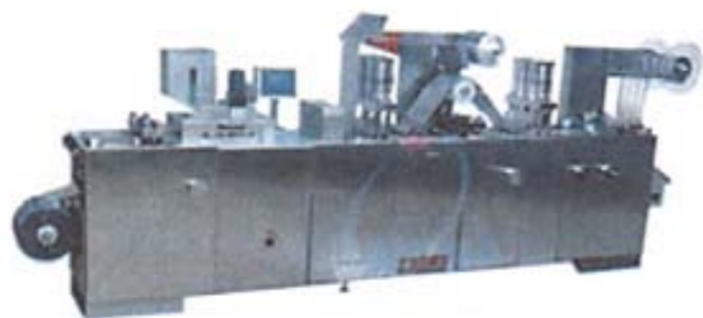
Блистерная машина DPP-250DII(DIII) китайского производителя LUXUN
