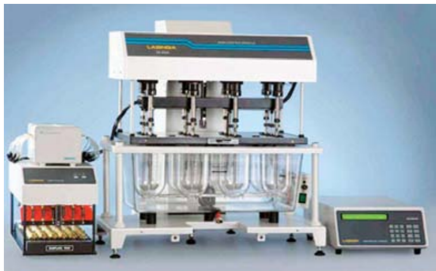
Рис. 2: Прибор для проведения теста «Растворение» DS-8000 (LabIndia)
