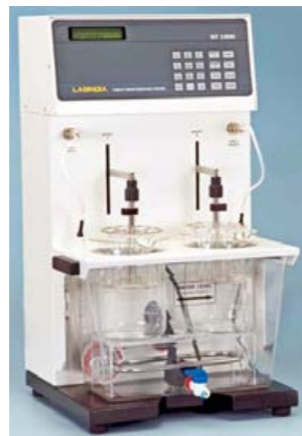
Рис. 1: Идентификатор процесса распадаемости DT-1000 (LabIndia)
