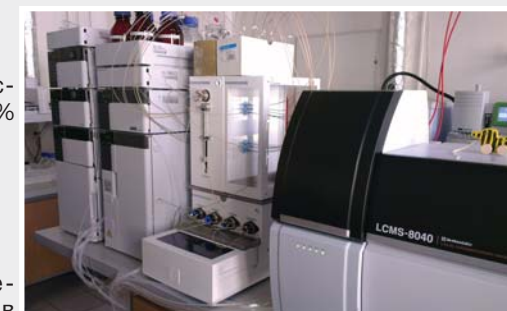
Рис. 3. Пример сопряжения онлайн-системы твердофазной экстракции ACE™ + HPD™. Spark Holland с тройным квадрупольным жидкостным хроматомасс-спектрометром LCMS-8040 Shimadzu
