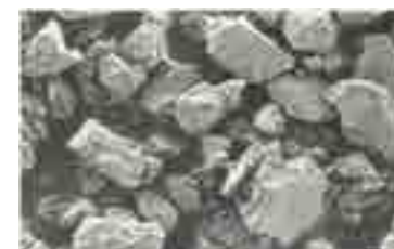
Рис. 4.1. Безводная β-лактоза (SuperTab®AN, Lactopress®Anhydrous).
