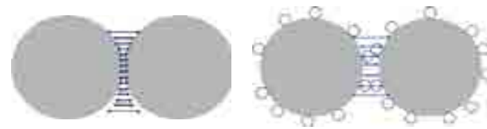
Рис. 3. Частицы притягиваются друг к другу под действием силы Ван-дер-Ваальса и других сил притяжения.
