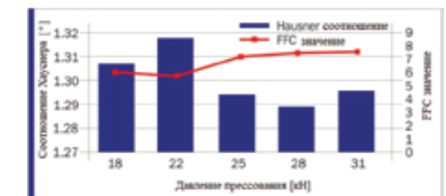
График 2: Зависимость сыпучести компактов PROSOLV® SMCC 50 от давления прессования при сухом гранулировании
