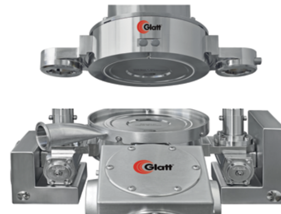
В системе TKS, диск клапана имеет одностороннее опирание, что значительно упрощает разборку узла для очистки и проверки по сравнению с другими конструкциями аналогичного назначения, где используется двухстороннее опирание
