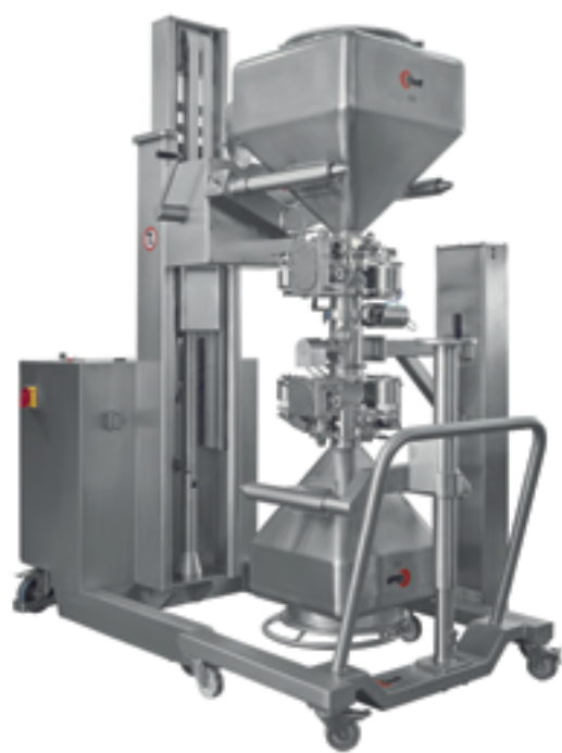
Клапан обеспечивает герметичную стыковку емкости и технологического оборудования, перекрывая все пути для пыли. Слева: классическая система перегрузки сыпучих материалов с трубчатым каналом. Справа: прямое подсоединение при помощи управляемого вручную клапана с активным и пассивным элементами
