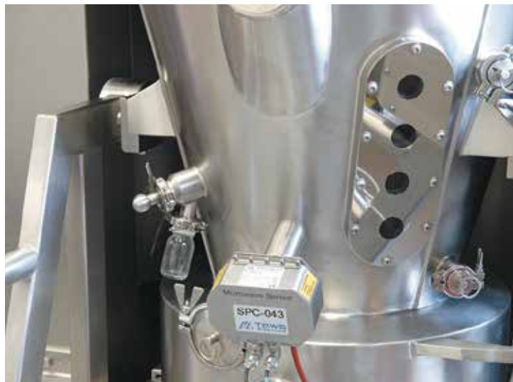
Рис. 2: Измерение процесса грануляции в реальном режиме времени с помощью программы TMV
