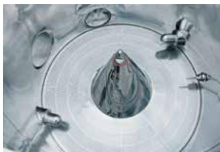
Рис. 2 Модуль Bohle Uni Cone BUC® с тангенциальными распыляющими форсунками в машине BFS 30
