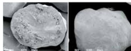
Рис. 7 СЭМ-фотографии гранул с замедленным высвобождением (вид в разрезе)
