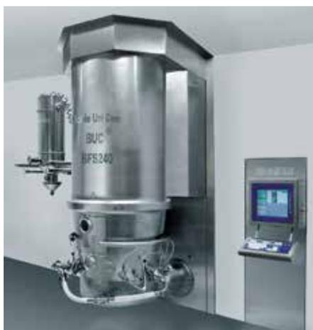
Рис. 1 Сушилка с псевдооживленным слоем Bohle BFS 240, включая HMI.
