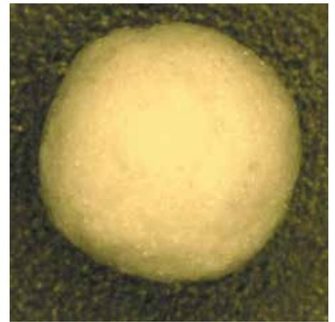
Рис. 5 Единичный сферический агломерат лактозы (оптический микроскоп, увеличение: 50 x)
