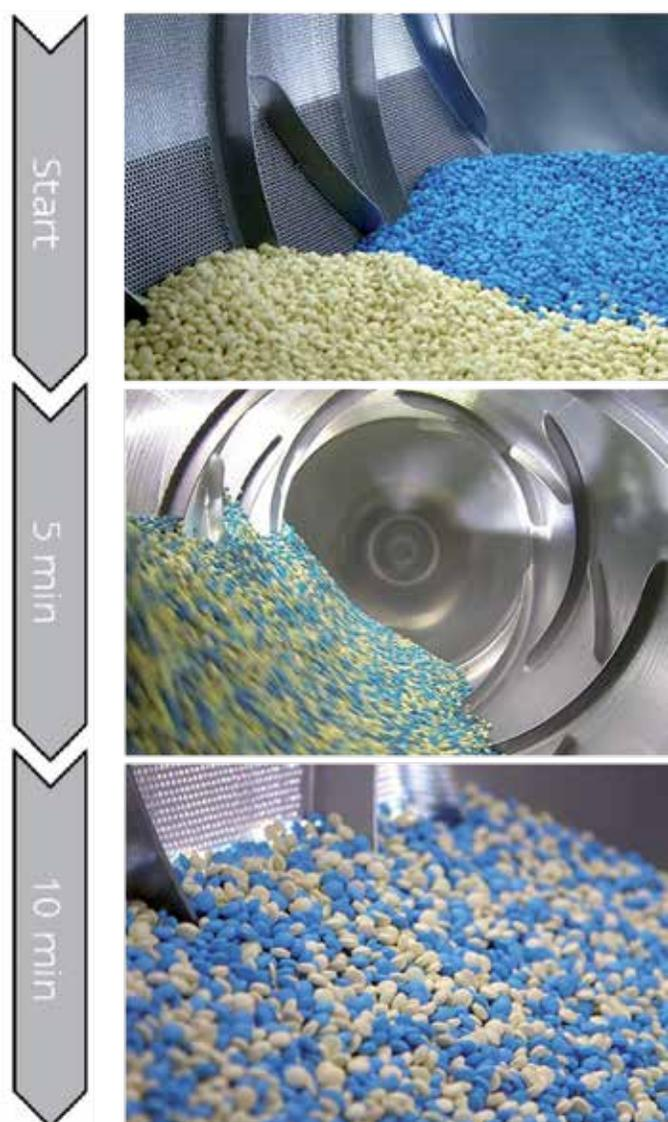
Этот тип смесителя отвечает специальным требованиям, предъявляемых к изготовлению кофе с добавками для капсул, в соответствии с требованиями к продукту, оснащён специально разработанными смесительными инструментами и с усиленным приводом.
