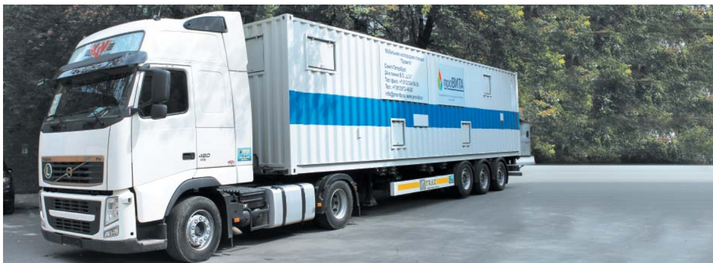
Фото 3. Мобильная кислородная станция
