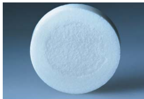
Рисунок 2. Дефекты поверхности таблеток с Магния стеаратом
