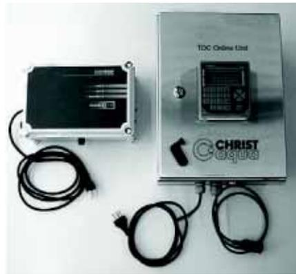
Рис. 16. Прибор контроля общего органического углерода **CHRIST**
