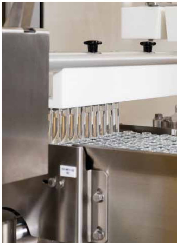
USD 100 – автоматическая выемка и позиционирование шприцев
