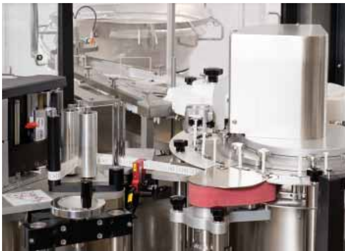
RIL 100 - монтаж поршней и этикетировка
