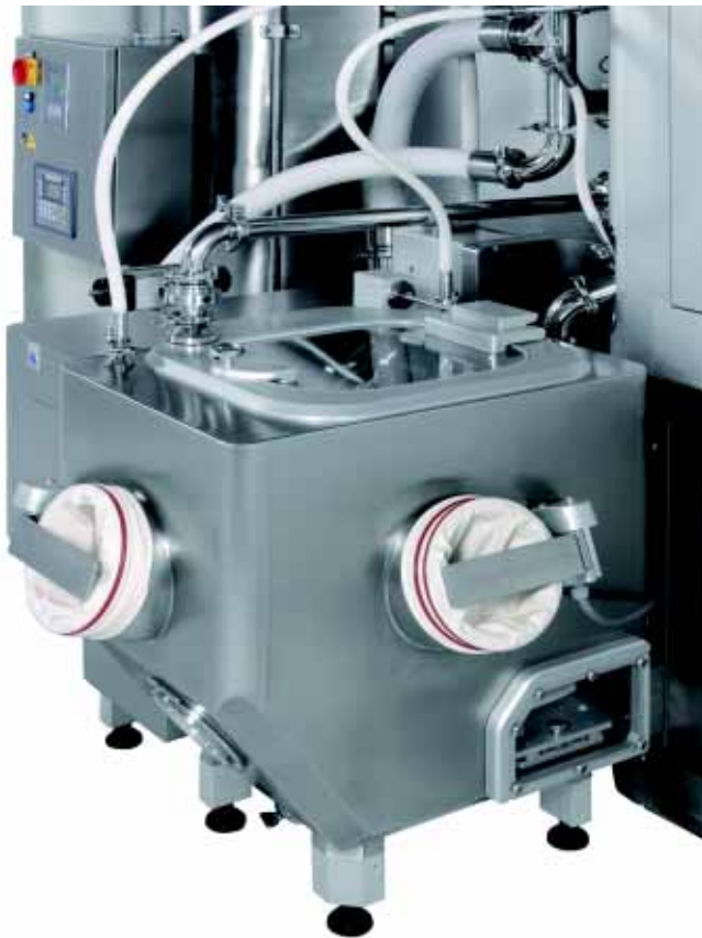
Рис.2 Устройство IPC, допускающее увлажнение, расположено внутри изолятора: перчаточные порты и порты RTP обеспечивают безопасный доступ и отбор образцов
