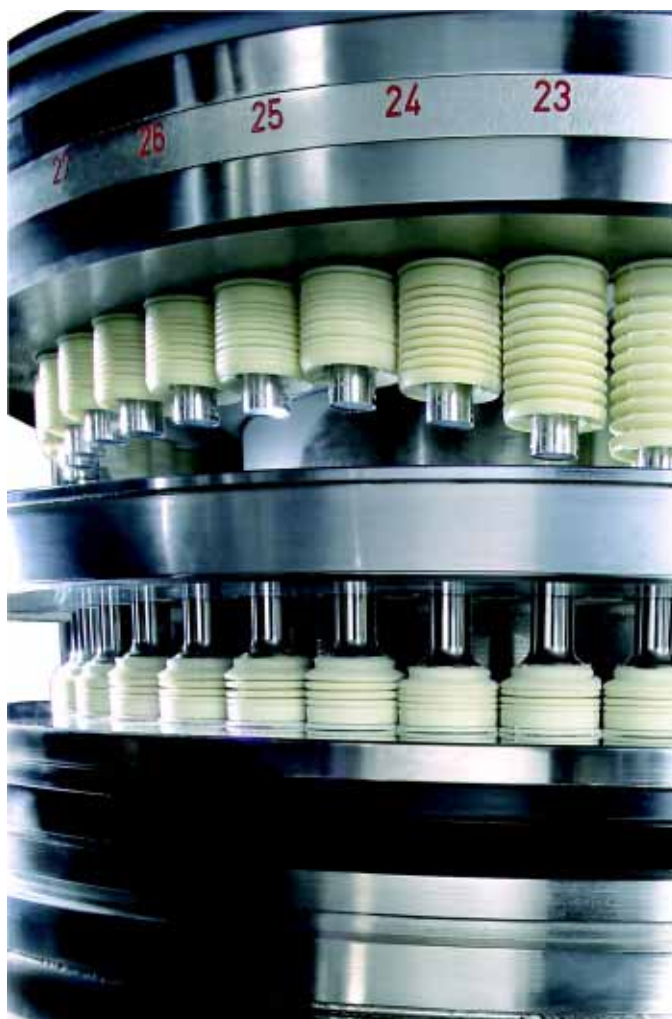
Рис.1 Прокладка и V-RING уплотнение на таблет-прессе мод. Synthesis
