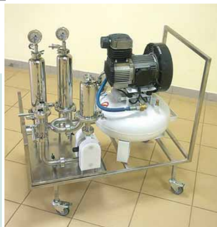
Фото 4. Установка с пневматическим мембранным насосом для фильтрации эфирных масел и других агрессивных жидкостей.
