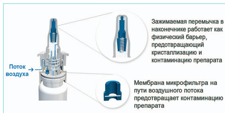
Рис. 1. Как в бесконсервантных многодозовых (БКМД) назальных спреях поддерживается стерильность системы
