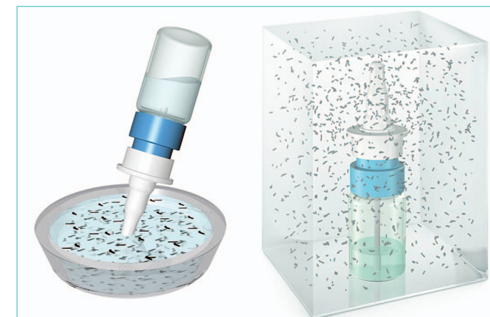
Рис. 6. Тесты на целостность и устойчивость к микробной контаминации (TSIT, слева) и тесты для проверки целостности упаковки и системы циркуляции воздуха (CVIT, справа) проведены с использованием устройств, заполненных средой для роста, для демонстрации устойчивости к микробной контаминации всего устройства
