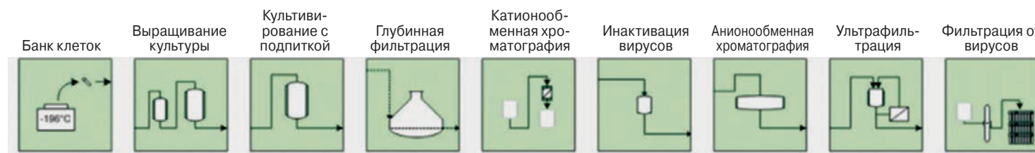
Рис. 1. Блок-схема процесса получения моноклональных антител
