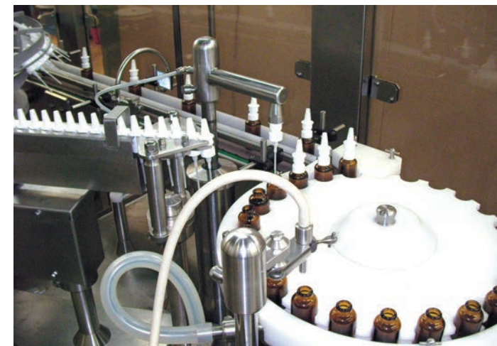
Рис. 5. В конце конвейера установлен механизм «проталкивания» флаконов, для того чтобы конвейерная лента не выходила за пределы ламинарной зоны (поз. 1) класса чистоты А. Все узлы и механизмы установлены на платформе поз. 12
