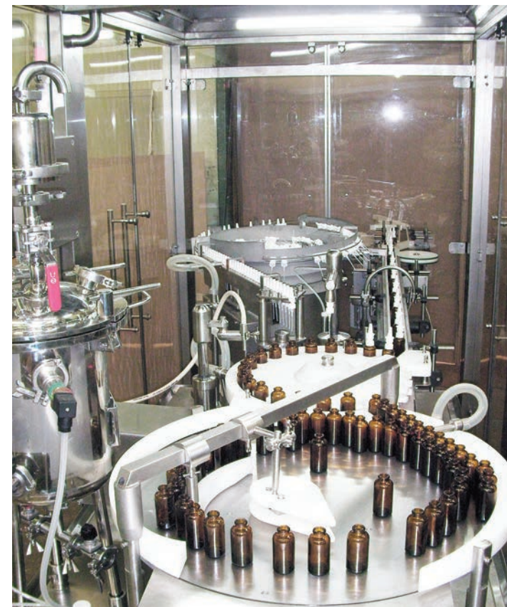
Рис. 4. После процесса дозирования флакон с помощью карусели перемещается в позицию надевания дозатора-распылителя
