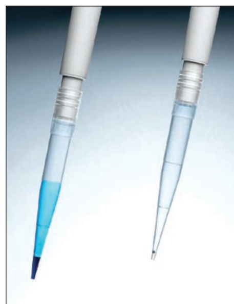
Рис. 1: Остатки жидкости на стандартном наконечнике для пипетки (слева) и на наконечнике для пипетки с малой задерживающей способностью Эппендорф ерТ.I.P.S. (справа)
