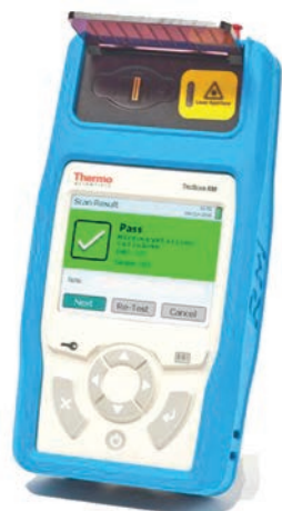
Рис. 4 Портативный Раман-анализатор Thermo TruScan RM
