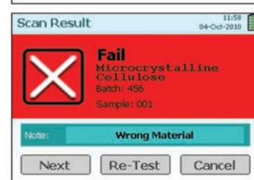
Рис. 6 Результат измерения на рамановском анализаторе ThermoTruScan
