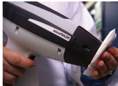
Рис. 2 Портативный БЛИК-спектрометр microPHAZIR – измерение субстанции через упаковку
