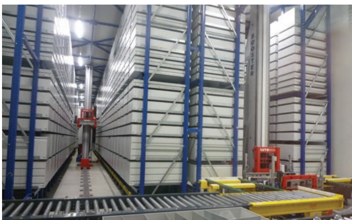
Конвейер для транспортировки коробок из зоны пикинга в зону отгрузки
