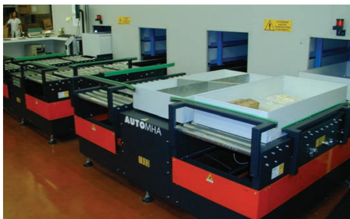
Зона выдачи и подбора товаров в автоматической системе Booster
