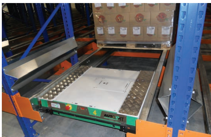
Радиошаттл AutoSat для палетных грузов в глубинных стеллажах
