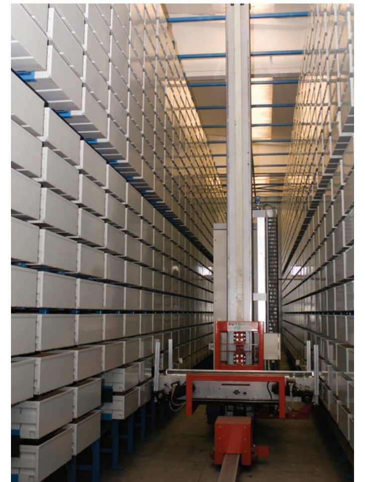
Автоматическая система хранения, распределения и подбора мелкоштучного товара Booster
