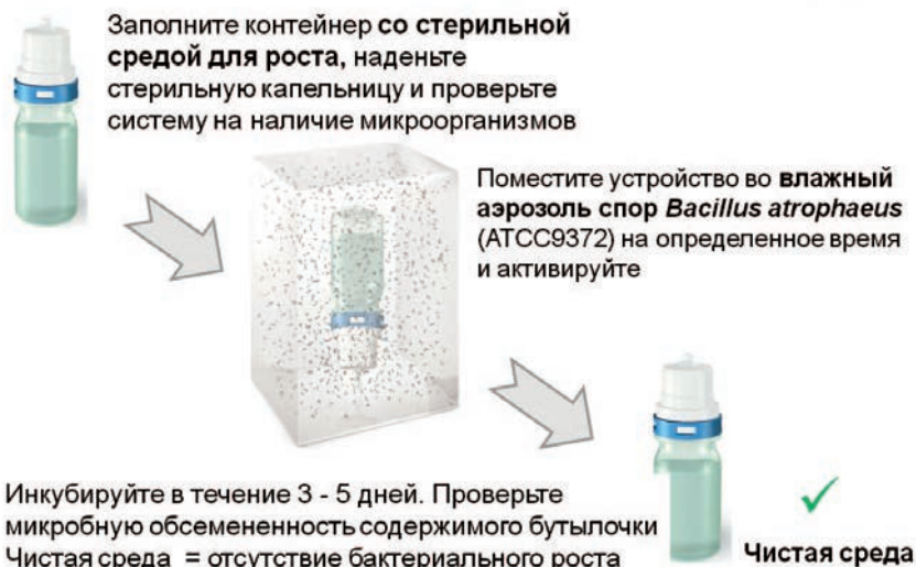
Рис. 4. Схема теста для проверки целостности укупорки и системы циркуляции воздуха для демонстрации устойчивости к микробной контаминации всего устройства в экстремальных условиях. В этом тесте подвергают микробной нагрузке систему циркуляции воздуха со стерильным фильтром, а также прочность защелкивающегося соединения капельницы и бутылки
