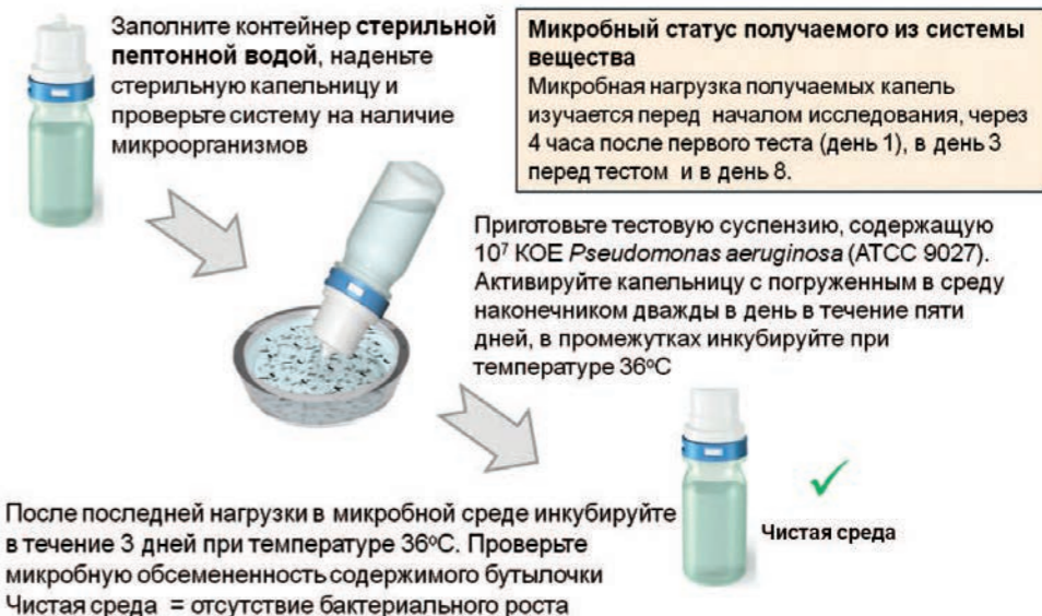
Рис. 3. Схема теста для проверки целостности перемычки наконечника устройства в экстремальных условиях
