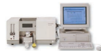
Рис. 3а. Атомно-абсорбционный спектрометр AA-6200
