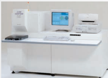
Рис.4б. Волнодисперсионный рентгенофлуоресцентный спектрометр XRF-1800
