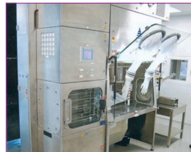
Изолятор включает в себя шлюз, в котором стерилизуются все производственные материалы, и производственную камеру. Готовый продукт помещается в «бесконечный рукав», который запечатывается парой располагаемых рядом сварных швов и разрезается.
