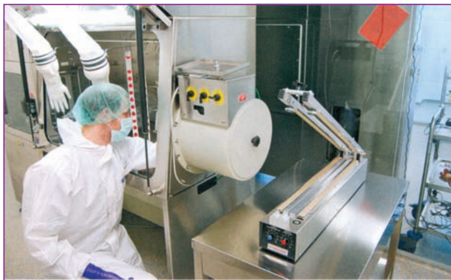
Для проведения очистки изолятор открывается спереди.
