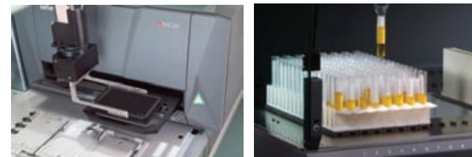
Роботизированные манипуляторы для планшетов (слева) и единичных объектов (справа)
