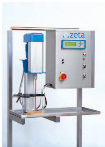
Лабораторная установка ЦЕТА для проверки параметров и результатов смешивания
