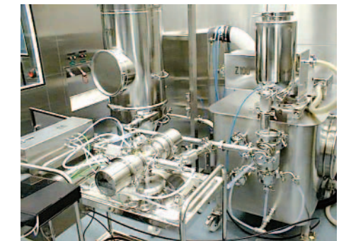
Встречно-струйная мельница с псевдоожженным слоем (AFG), on-line установка
