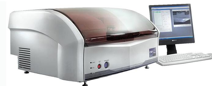
Фото 3. Автоматическая станция химической обработки мембран с разделенными белками Shimadzu ChiP 1000
