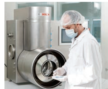
Solidlab 1 Универсальное решение для твердых форм. Лабораторные установки Solidlab 1 и Solidlab 2 объединяют все модули процесса изготовления твердых форм в одной машине: смешивание порошков, сушку в кипящем слое, грануляцию и покрытие оболочкой.
