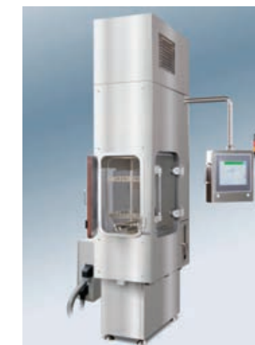
ISS 1000 Воздушный шлюз Fast Airlock ISS 1000 для быстрой передачи фармацевтических материалов в изолятор и из изолятора. Эффективный метод обработки паром и оптимизированное количество передаваемого материала дают возможность сократить время цикла передачи до 20 минут.
