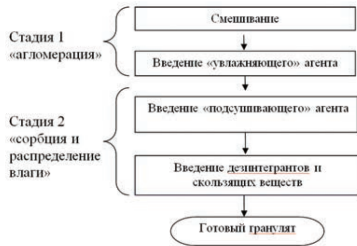
Рис. 2. Схема влажноактивированной грануляции
