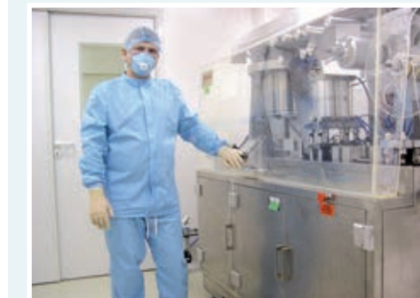
Фото 2. Работа на блистерном автомате
