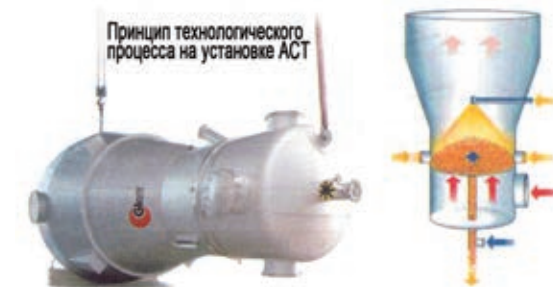
Рис. 13. Установка непрерывной грануляции и сушки AGT 2700 Glatt
