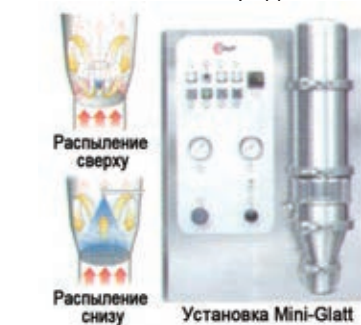
Рис. 8. Грануляторы псевдооживленного слоя периодического действия фирмы Glatt
