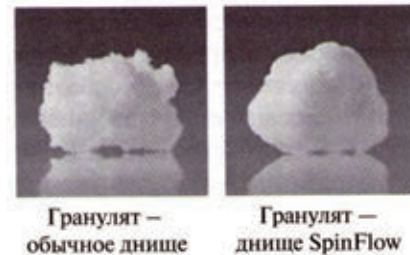
Рис. 10. Гранулы, полученные в аппаратах ПС с разным типом днищ
