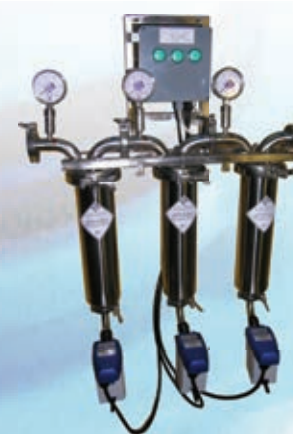
Фото 1. Трехступенчатая система для очистки газов с автоматическими конденсатоотводчиками
