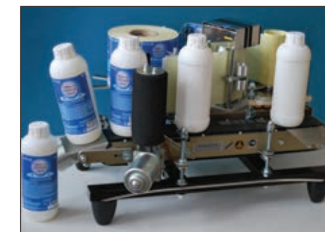
Рис. 3. Внешний вид этикетировочной машины ЭМ-4П.Мини для нанесения самоклеящихся этикеток на цилиндрическую литровую тару. Производительность до 2000 этикеток в час.
