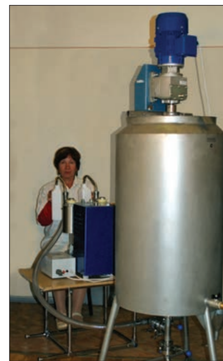
Рис. 2. Оптимизированный (без промежуточной накопительной ёмкости) вариант установки приготовления ветеринарных препаратов в форме растворов обеспечивает возможность работы как в режиме «Приготовление продукта», так и в режиме «Подача готового продукта на установку розлива»
