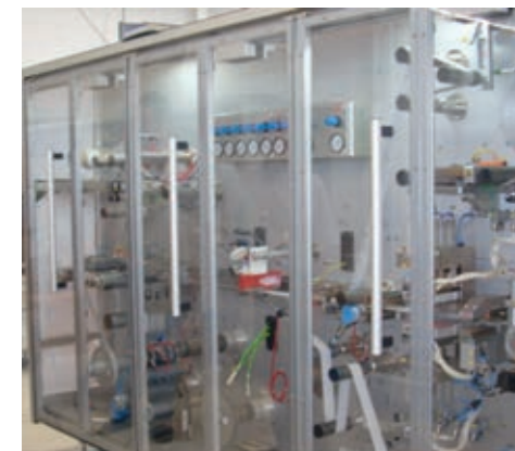
Фото 4. Лабораторная машина для получения трансдермальных пластырей и трансбуккальных пленок «PML-100», пр-ва фирмы «Harro Höfliger»
