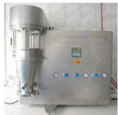
Фото 3. Установка для грануляции «Mucrolab», пр-ва фирмы Oyster Hüttlin (технология «кипящего слоя»)
