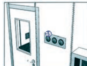
Рис. 3. Схема размещения блока контроля перепада давлений
