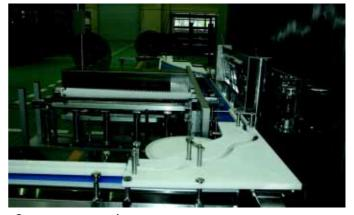
Система загрузки/разгрузки продукта
